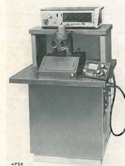
Fig. 1. — Apparecchiatura per la produzione del segnale televisivo completo, registrato olograficamente, posta sopra un normale televisore usato per la riproduzione.
