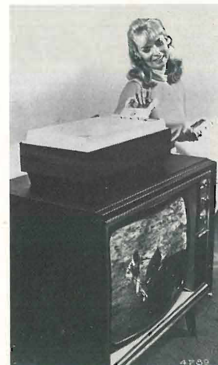
Fig. 1. — Apparecchiatura per la produzione del segnale televisivo completo, registrato olograficamente, posta sopra un normale televisore usato per la riproduzione.
