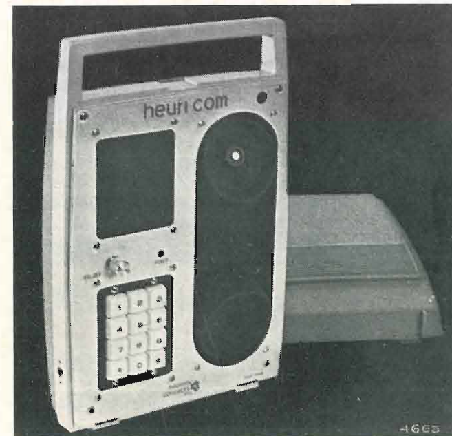
Fig. 2. — Adattatore per l'uso di tastiera con comuni telefoni a disco combinatorio.
